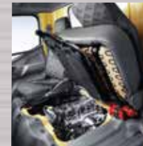
Inspection Lid Berada di bawah jok penumpang, pengecekan mesin lebih mudah.
