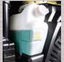
Tangki Radiator Posisi di bagian luar sehingga mudah dikontrol.
